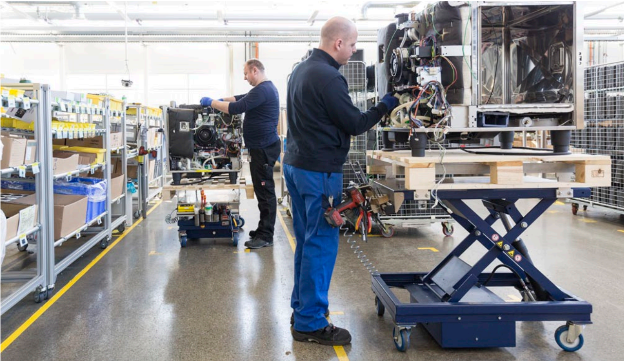
Montage „Ein Mann – ein Gerät“
